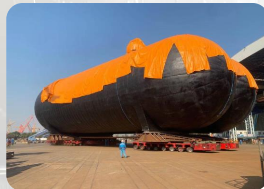
16,020cbm LNG Cargo Tank
