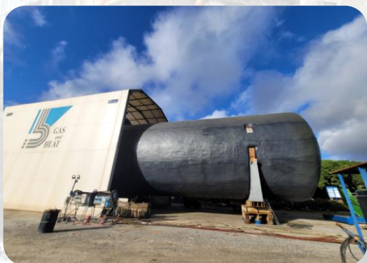
2500cbm LNG Bunker Tank
