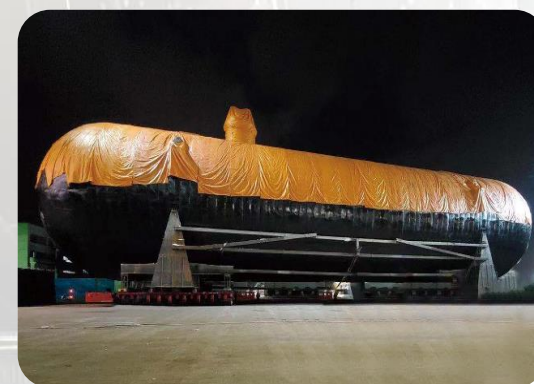
14,000cbm LNG FRU Tank
